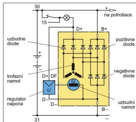
119. Kako se u alternatoru postigne promjena mehaničke energije u električnu energiju? (1 bod)
