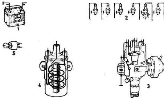
164. Kod baterijskog paljenja kondenzator štiti kontakte platina od izgaranja i povećava energije iskre: (1 bod)
